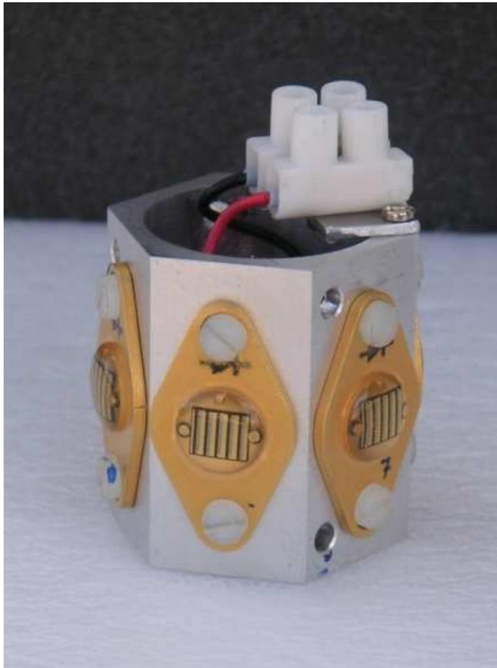
**Abbildung 4.1:** Foto des UV-LED-Rings. Dieser hatte insgesamt ein Gewicht ein Gewicht von 80 Gramm. Die Höhe betrug 40 mm und der äußere Durchmesser 38 mm.
