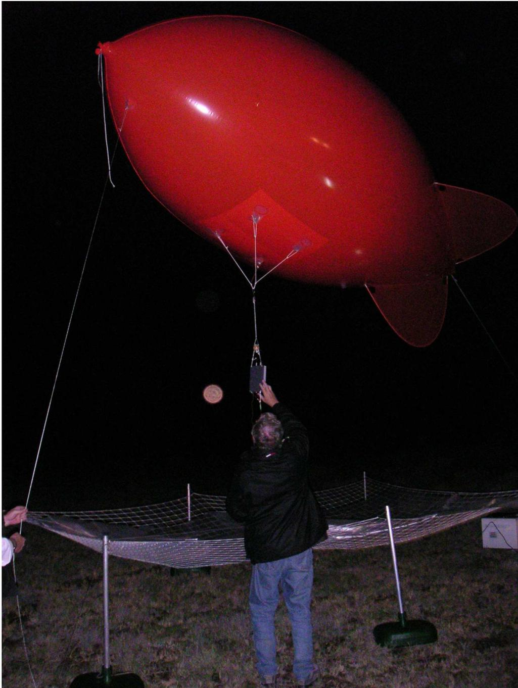
**Abbildung 4.6:** Foto des Fesselballons. Dieser hatte ein Füllvolumen von  $7.5 \text{ m}^3$  und eine Nutzlast zwischen 3 und 4 kg auf Meereshöhe. Zu erkennen ist auch der UV-LED-Ring mit Elektronik und links davon der Vollmond.
